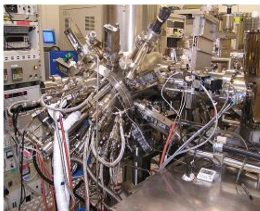
分子線エピタキシー(MBE)装置： 高品質の半導体や超格子構造を作る のに適している装置
